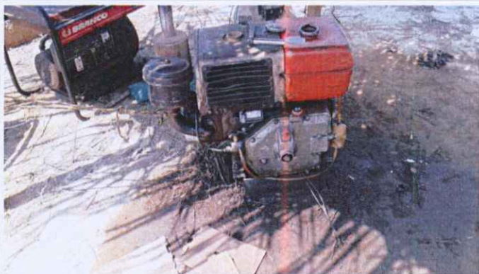
Gerador com óleo vazando para o solo
