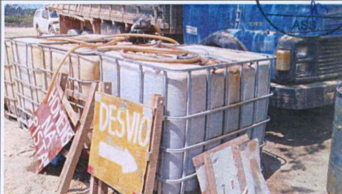
Armazenamento de combustível em vasilhames plásticos
